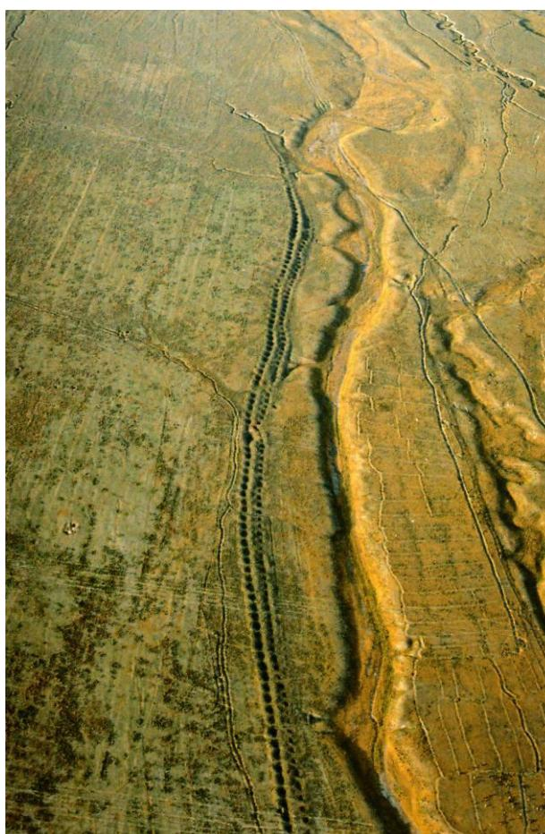
*Рис. 3 - Аэро-фотосъемки 1 кяризной системы с двойной линией в ТАМ, зона 7.2*
